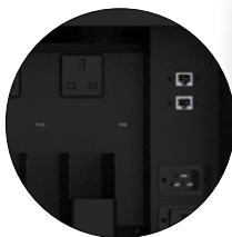
Ethernet and AC daisy chains Chaînes de connexion Ethernet et de courant alternatif
